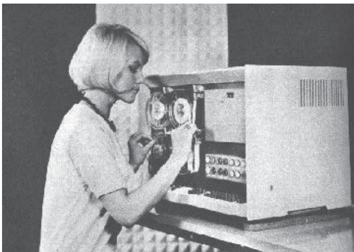
Die D1 bestand aus 760 Elektronenröhren und führte 100 arithmetische Operationen pro Sekunde durch.
